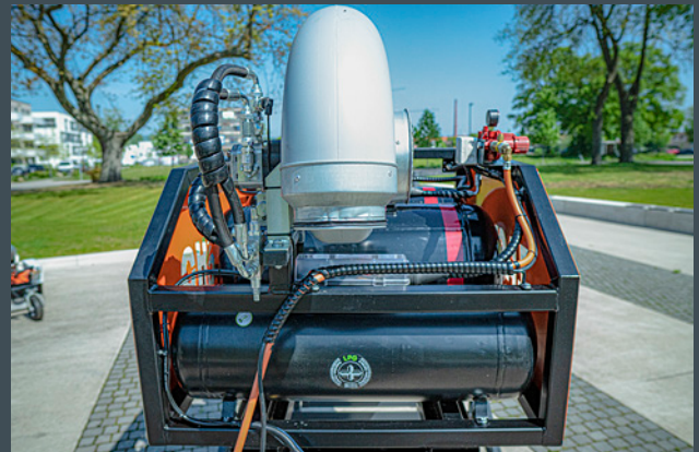
60 Liter Tank für ca. 7 Stunden Laufzeit des Gasmotors
