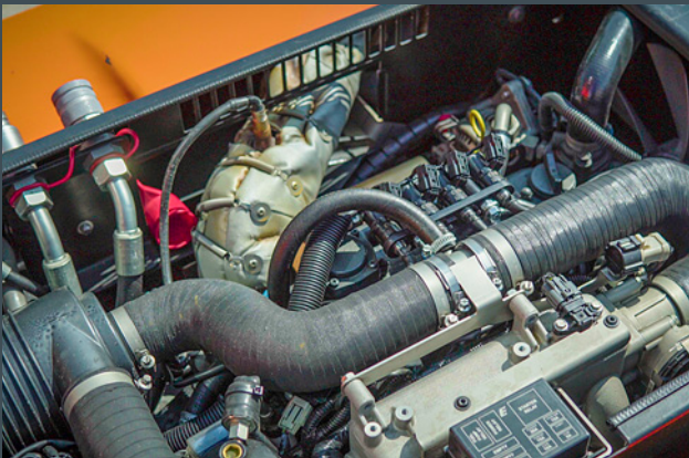
Kubota Benzin Motor mit PRINS Gasanlage auf LPG umgebaut
